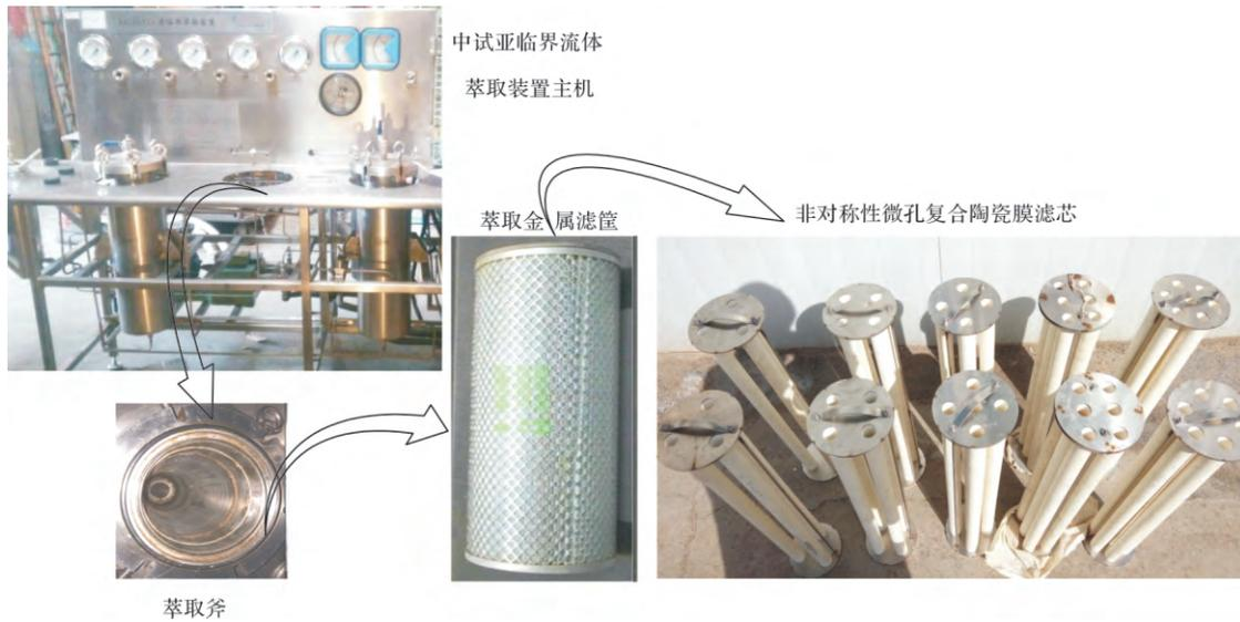
图 1 萃取滤芯改造前后示意图
