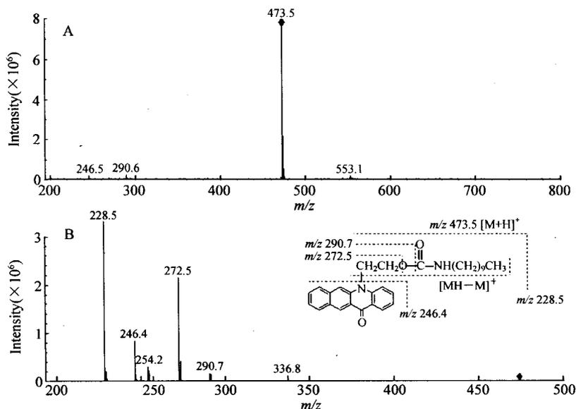
图 2 BAEIC-癸胺衍生物质谱图:一级质谱(A),二级质谱(B)
